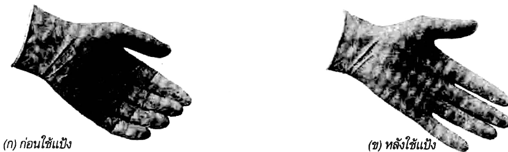
รูปที่ 3 แสดงปัญหาการยึดติดของถุงมือยางธรรมชาติ (ก) ก่อนใช้แป้ง และ (ข) หลังใช้แป้ง
